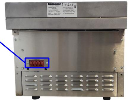
4 - Avant la mise sous tension, remettre en place le capot de protection :
